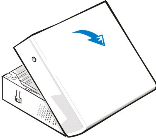
Resim 2. Alçak profilli bilgisayar kapağının değiştirilmesi
